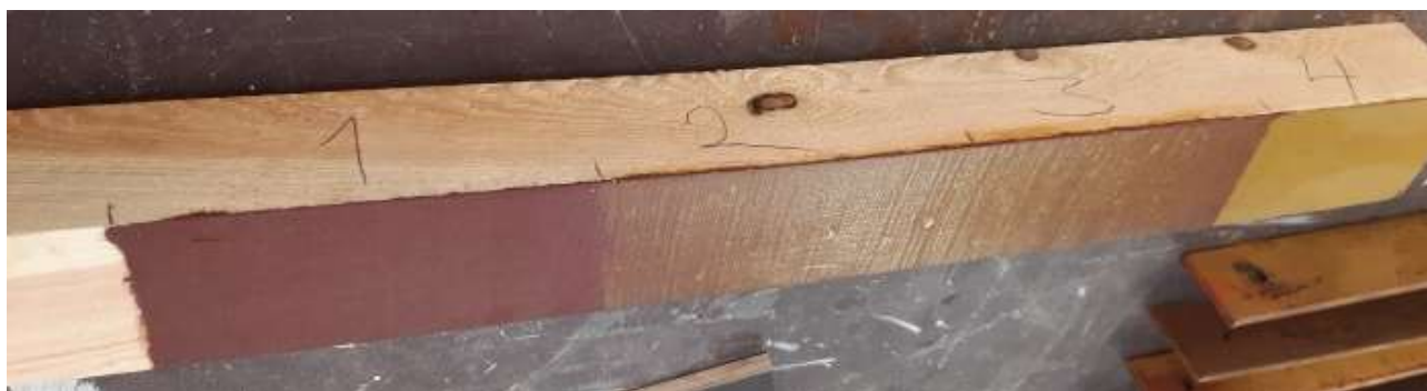
Koemaalauslankku 23.3.–21 – kolmososiosta puuttuu ohentamaton pintamaali. Kuva Kirsi Mielonen/Juvan kunta.
