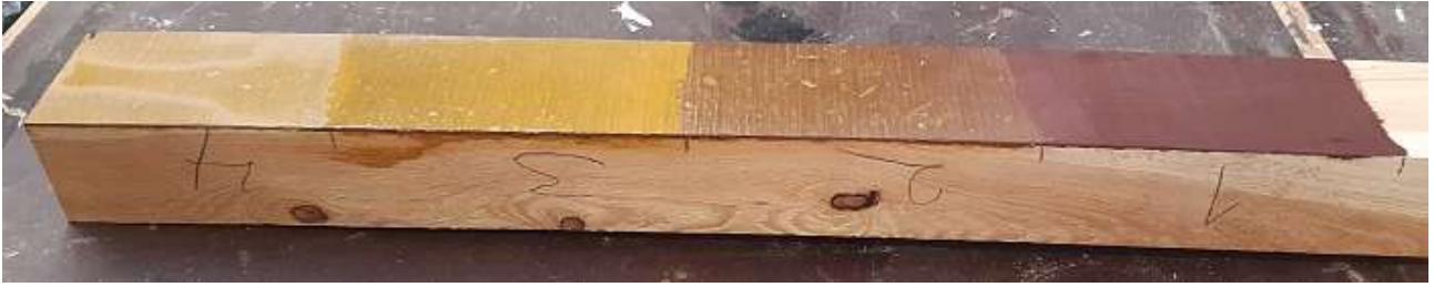
Koemaalauslankku 7.4.–21 – kaikki kerrokset on maalattu. Osio kolme märkä. Kuva Kirsi Mielonen/Juvan kunta.
